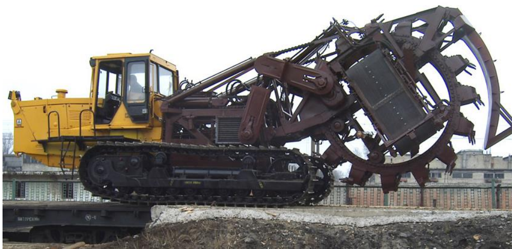
1.2-сурет – Шынжыр табанды айналмалы траншеялы экскаватор
